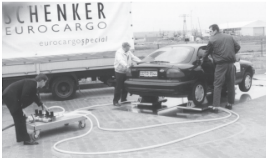
Zur Schenker-Einweihung gab es viel Know How zu sehen. Wie dieser Pkw werden in Elektronikbetrieben die Lkws auf Luftkissen in die Werkhallen gefahren. Zweck: diese Werkhallen müssen völlig erschütterungsfrei sein. Auf dem Luftkissen läßt sich das Fahrzeug von Hand bewegen.
